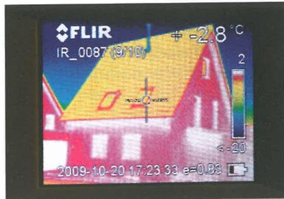
Werkzeug des Energieberaters: Das Bild der Wärmekamera verrät, wo die größten Verluste entstehen. BSB
